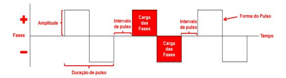
Figura 1: Esquema do pulso elétrico.
